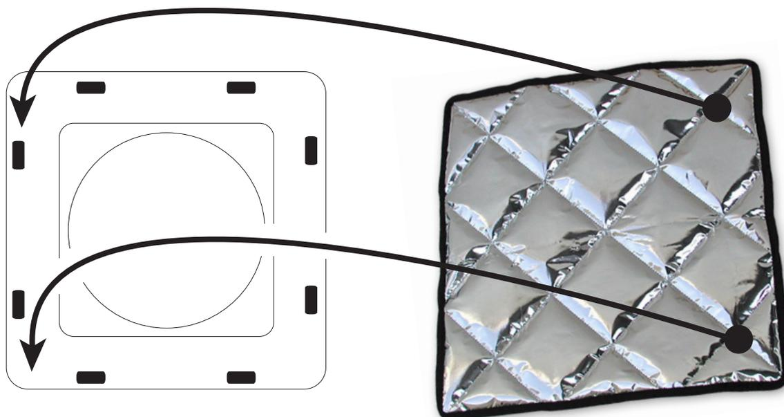
4. マジックテープ(メス)が銀色面に接着したのを確認し、マジックテープ同士を一旦はがして、マジックテープ(メス)を銀色面にもう一度しっかりと圧着すれば完了です。
