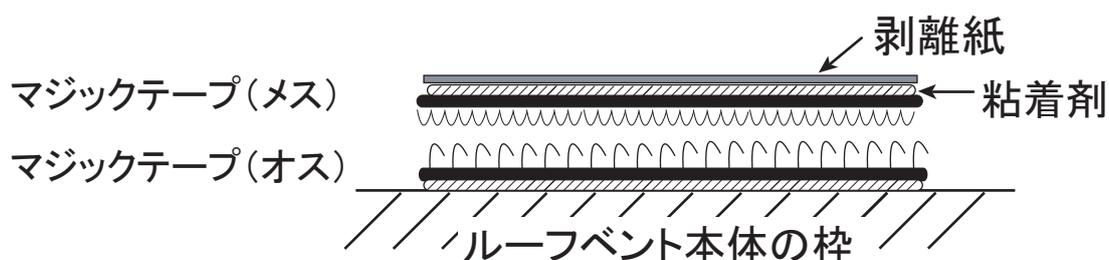
3. マジックテープ(メス)の剥離紙を剥がし、マルチシェードの銀色面(外側面)を慎重に貼り合わせます。
