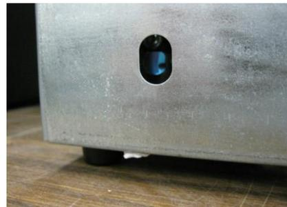
⑤ 着火が確認できたら押し回した状態のガス操作ダイヤルから約 10 秒後に手を放し**点火完了**です。
