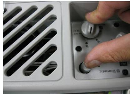
③ ガス操作ダイヤルを押したまま点火ボタンを数回押します。
