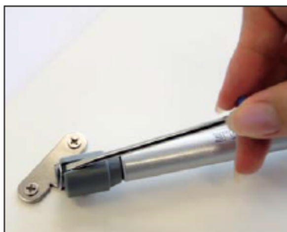
2-2. グレーのブラケットの溝にマイナスドライバーを差し込む
