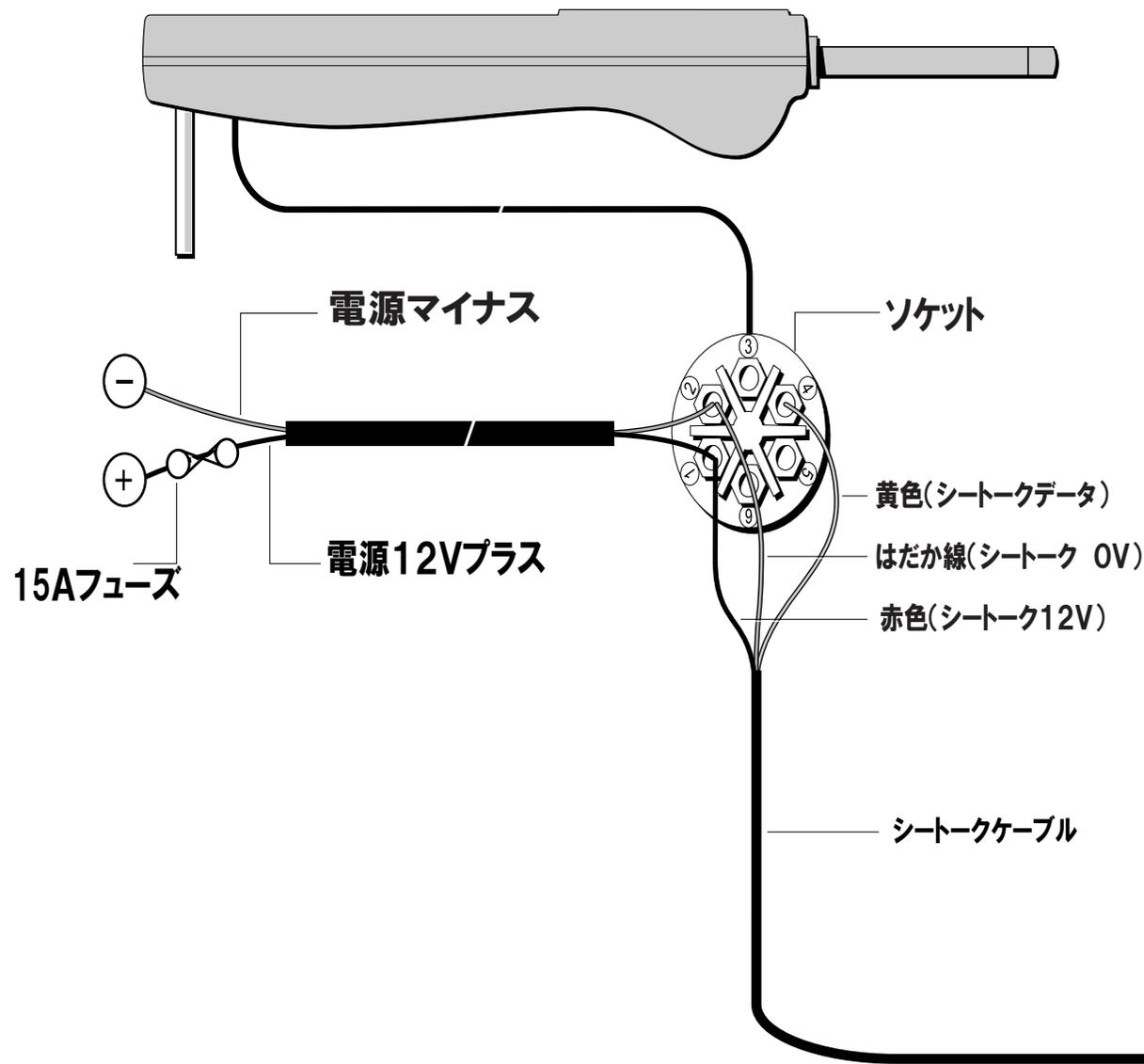
ティラーパイロットの電源コネクタの裏側の端子にベースステーションよりのシートケーブルの配線を接続すればOKです
