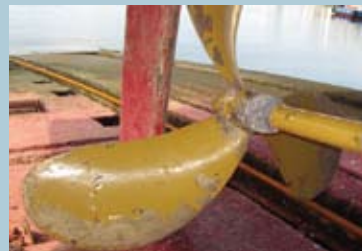
海中生物や汚れを除去した状態
