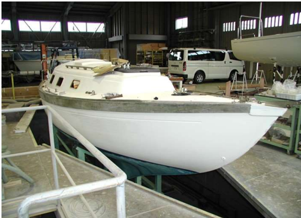
26ft艇 ガンネル補修、ハッチ新設、水漏れ補修、窓交換
