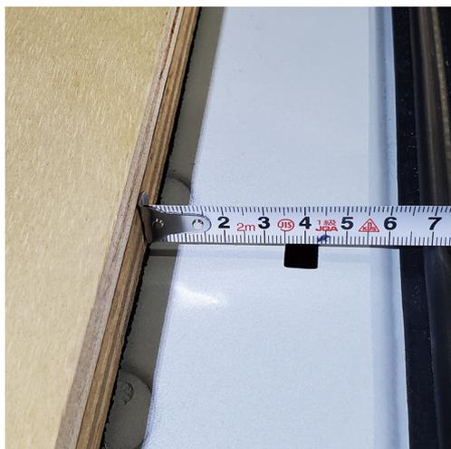
フロアパネルはバックドアの角穴先端から前方 35mm の位置に配置してください。
