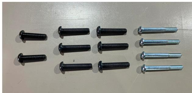
前脚部：ボルト（ボタンキャップ M10 x 40 黒色クロメート）にワッシャー（M10 1.6）を通し、前脚部を固定します。
