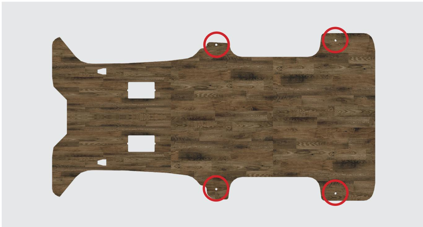
ボルト ( ボタンキャップ M8x70 黒色クロメート ) にワッシャー ( M8 1.6 ) を通し、タイダウンフックを 4 箇所 固定します。
